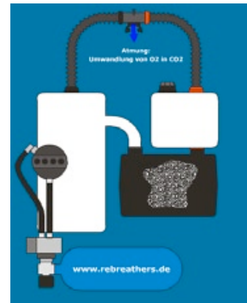
FUNKTIONSPRINZIP EINES HALBGESCHLOSSENEN KREISLAUFGERÄTES MIT KONSTANTDOSIERUNG
