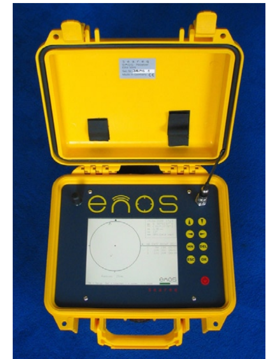
MOBILE EMPFÄNGEREINHEIT DES ENOS-SYSTEMS, BEVORZUGT FÜR DEN EINSATZ AUF SCHLAUCHBOOTEN. DIE EINHEIT IST SPRITZWASSERGESCHÜTZT
