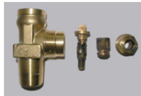
INNERER SAUERSTOFFBRAND IN EINEM VENTIL, WELCHES DIE SAUERSTOFFAUSBRENNENSICHERHEITEN ERFÜLLT. VENTILKÖRPER BRANNTE NICHT AUS
