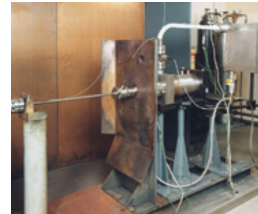
500-BAR-SAUERSTOFF-DRUCKSTOSSPRÜFSTAND FÜR ARMATUREN UND ANLAGENTEILE DER BAM
