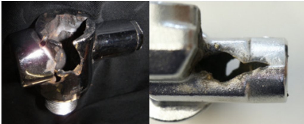
LUFTVENTILE, DIE WEGEN SAUERSTOFF AUSBRANNTEN. JE EIN FALL AUS DEUTSCHLAND UND DER SCHWEIZ
