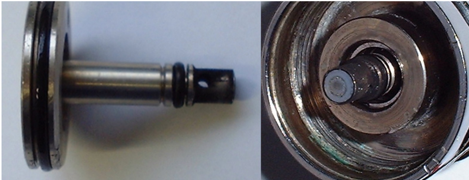
SAUERSTOFFBRAND IN EINEM LUFTAUTOMATEN MIT EINEM SAUERSTOFFGEMISCH VON „NUR“ 29% SAUERSTOFF (EAN29) ZEIGT AUF, DASS DIE 23% GRENZE SEHR WOHL BERECHTIGT IST
