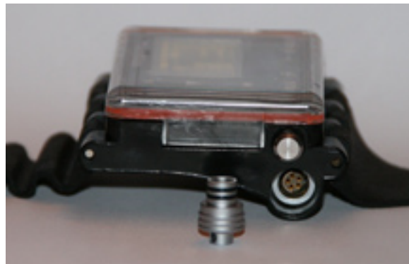
EIN BLINDSTOPFEN SCHÜTZT DEN INTERFACE-ANSCHLUSS
