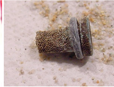
SCHLECHTE ZUSTÄNDE DES ATEMREGLERS WIE DIESE SIND LEBENSGEFÄHRLICH, TOTALAUSFÄLLE VORPROGRAMMIERT. SINTERFILTER WIE DIESE (FOTO MITTE) ERZEUGEN SCHLECHTE ATEMLUFT, STATT SIE ZU REINIGEN. SIEHT DAS INNERE DER ZWEITEN STUFE SO AUS, SIND SOGAR GESUNDHEITLICHE SCHÄDEN ZU BEFÜRCHTEN!
